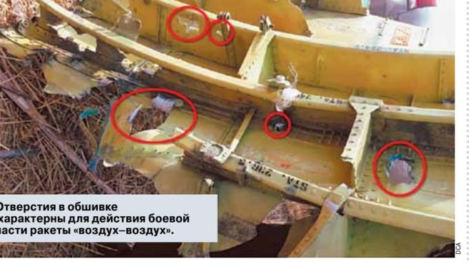
Отверстия в обшивке характерны для действия боевой части ракеты «воздух-воздух».
