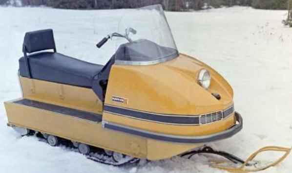
В 1970 году началась разработка опытного образца снегохода, а уже в марте 1971-го был изготовлен первый снегоход «БУРАН» с двигателем от мотоцикла «ИЖ-Юпитер-3».
