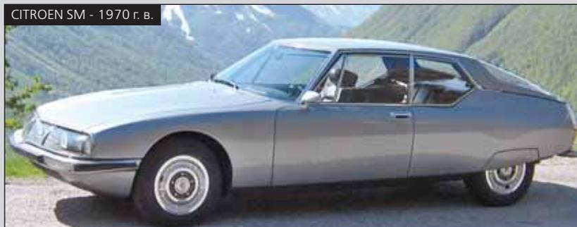
системы поддерживалась за счет насоса, создававшего высокое давление. Это было принципиальное отличие подвески Мажеса от похожей, но более простой английской системы Hydrolastic, работавшей по принципу сообщающихся сосудов. У «Ситроена» же управление насосом посредством рычага на приборной панели позволяло принудительно фиксировать дорожный просвет в одном из пяти положений в диапазоне от 90 до 280 мм. DS мог даже ехать на трех колесах и обходиться без домкрата.
