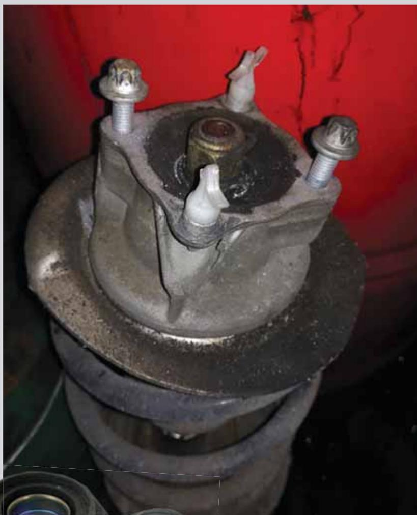
димо с нижней стороны стойки, отсоединив ее от поворотного кулака. После этого отсоединяется верхняя опора. Снимая пружину, нужно пользоваться специальным съемником, не применяя в этой операции каких-либо подручных приспособлений.
