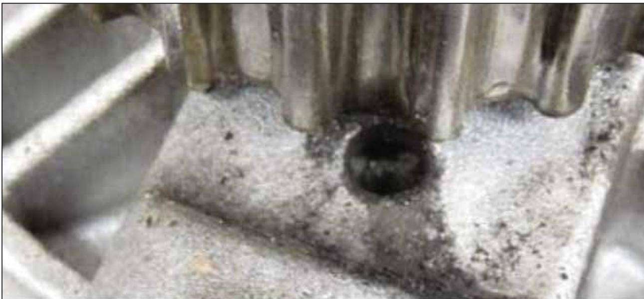
Рис. 3. Негерметичность в месте дренажного отверстия
