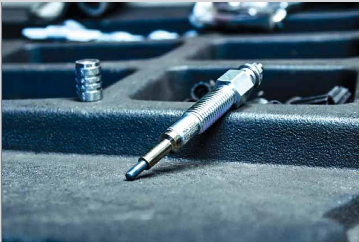
Инженеры компании назвали свечи накаливания героями выхлопной системы, так как именно они снижают объем выбросов, защищая клапаны рециркуляции отработавших газов (EGR) и проводя регенерацию сажевого фильтра (DPF).
