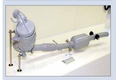
Система эффективно сокращает выбросы оксидов азота, производимые дизельным двигателем, превращая их в водяной пар и молекулярный азот. Конструкция системы состоит из нескольких компонентов: резервуара для жидкости AdBlue; аддитивного инжектора, вводящего жидкость в выхлопную систему; кольца, которое смешивает распыленную жидкость с выхлопными газами; катализатора и электроники с несколькими датчиками, обеспечивающими правильную работу.
