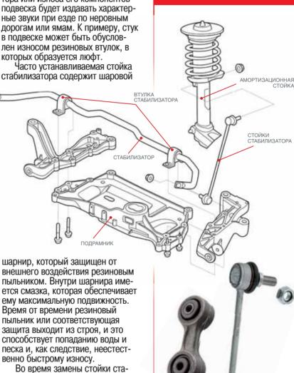
билизатора финальную протяжку следует осуществлять с применением динамометрического ключа, соблюдая рекомендованное производителем запчасти усилие. Если стойки затянуть неправильно, это может привести к интенсивному износу запчасти и полному выходу ее из строя.
