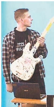
При включении гитары на фоторезисторы направляются 6 лучей лазерных диодов, каждый луч является аналогом струны. Когда музыкант играет, он перекрывает пальцами лучи. Фоторезистор при этом изменяет своё сопротивление в меньшую сторону, контроллер преобразует сигнал
